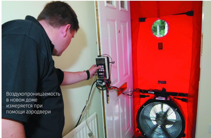
Воздухопроницаемость в новом доме измеряется при помощи аэродвери
