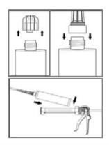
Desenroscar el tapón del cartucho y fijar firmemente la boquilla mezcladora.
